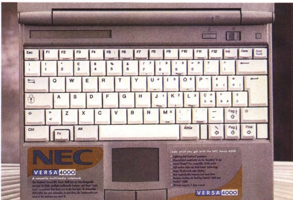
La tastiera estesa a 83 tasti è stata sistemata in una posizione arretrata in modo da creare sul davanti uno spazio su cui poggiare i polsi.
